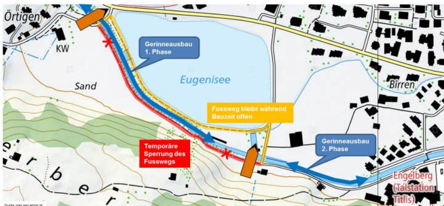
Parallel zum Gerinneausbau der 2. Bauetappe erfolgen die Abschlussarbeiten der 1. Bauetappe (Bergbahnen bis Sodbrücke). Neben den grossflächigen Rekultivierungs- und Bepflanzungsarbeiten werden unter anderem der Tennisplatz beim Sportpark und die Fusswege im Baubereich instandgesetzt. Zum Abschluss der 1. Bauetappe erfolgen gegen den Sommer die Deckbelagsarbeiten in den Gebieten Bergbahnen/Birkenstrasse, Rohrbrücke und Bänklialpweg.
